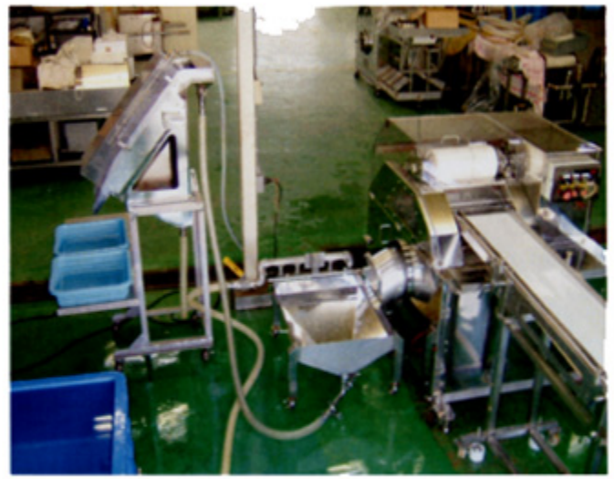
魚卵連続分離装置 FRS-102型 連結時
